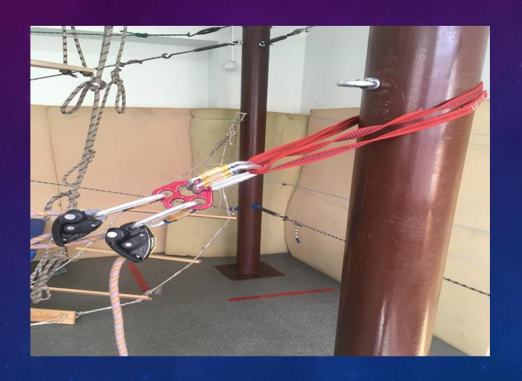
После чего ставим "Полиспаст" и с его помощью делаем натяжение на обе верёвки поочерёдно (т.е сначала натягиваем первую верёвку, а затем вторую).
