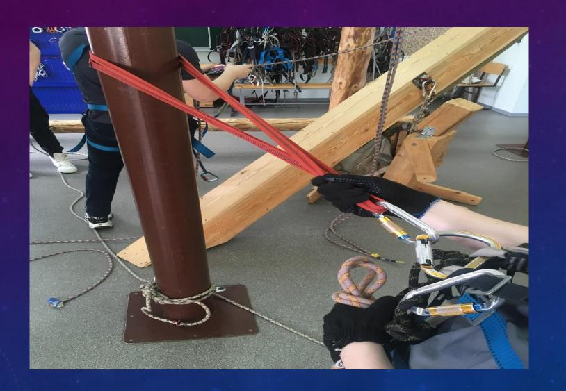
Фиксируем верёвку на столбе через карабинную удавку (двумя карабинами, так как двойная верёвка).
