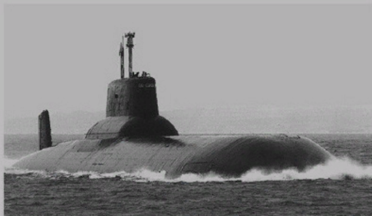
Рис. 3. Тяжелый атомный подводный крейсер с баллистическими ракетами проекта 941 «Тайфун»: водоизмещение надводное (подводное) — 28500 (49800) т; длина — 171,5 м; ширина — 24,6 м; осадка — 13 м; скорость хода подводная — 27 узлов; экипаж (офицеры) — 163 (55) чел.; автономность — 120 суток; глубина погружения — 500 м; вооружение — 20 МБР, торпедные аппараты, ПЛУР, ЗУР, торпеды, гидроакустические станции, радиоэлектронные средства противодействия
