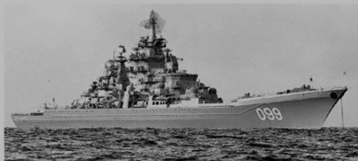
Рис. 4. Тяжелый атомный ракетный крейсер проекта 1144 «Петр Великий»: водоизмещение стандартное (полное) — 19 000 (24 300) т; длина — 252 м; ширина — 28,5 м; осадка — 9,1 м; скорость хода максимальная — 30 узлов; дальность плавания (при скорости) — 14 000 миль (30 узлов); экипаж (офицеры) — 744 (82) человека; вооружение — ударное (ПУ ПКР), зенитное, артиллерийское, противоторпедное, противолодочное, авиационное (3 Ка-27), радиоэлектронное
