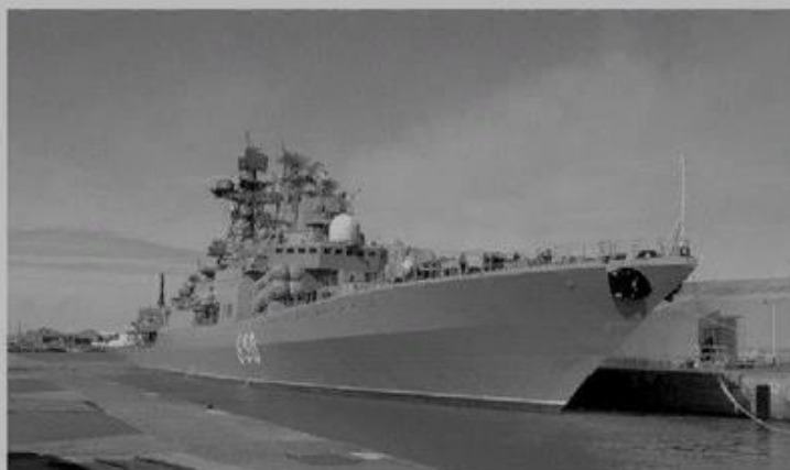
Рис. 5. Эскадренный миноносец «Адмирал Чабаненко»: водоизмещение стандартное (полное) — 7700 (8900) т; длина — 163,5 м; ширина — 19,3 м; осадка — 7,5 м; скорость хода максимальная — 30 узлов; дальность плавания (при скорости) — 4000 миль (18 узлов); экипаж (офицеры) — 296 (32) человек; вооружение — ударное (ПУ ПКР), зенитное, артиллерийское, противолодочное, авиационное (2 Ка-27), радиоэлектронное
