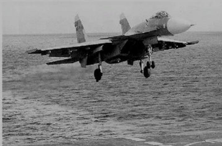
Рис. 6. Истребитель корабельного базирования Су-33: размах крыла — 14,7 м; длина 21,19 м; высота — 5,63 м; масса максимальная взлетная — 32 000 кг; максимальная скорость на большой высоте -2300 км/ч; потолок — 17 000 м; дальность — 3000 км; вооружение — 30-мм пушка (250 патронов), УР; экипаж — 1 человек
